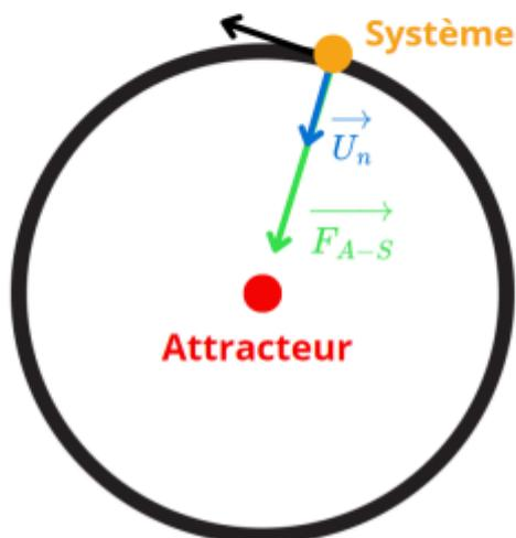
Cas des mouvements satellitaires : attention, la distance  $d$  est bien celle partant du centre de l'attracteur au centre du système. Dans le cadre du mouvement d'un satellite, il s'agira ainsi de la distance partant du centre de la terre au centre du satellite ainsi on aura  $d_{A-S} = R_T + h$  où  $h$  est la distance séparant le centre du satellite à la surface de la terre (on parle de hauteur du satellite). La force gravitationnelle s'écrirait alors :
