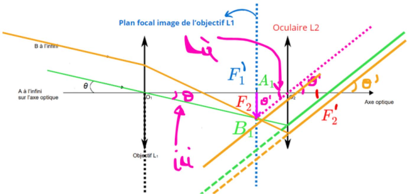
**Etape 3** : exploiter les triangles  $O_1A_1B_1$  et  $O_2A_1B_1$  grâce à la formule de la tangente
