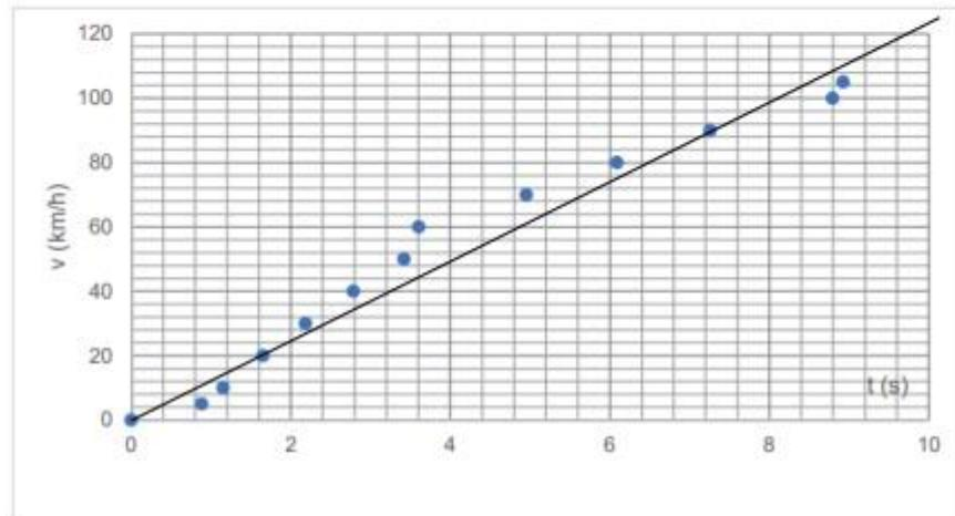
Si on nous donne le graphe de la fonction  $V(t)$  alors l'accélération en un point correspond à la pente de la tangente en ce point. Si le graphe est une droite comme sur la figure ci-dessus, alors l'accélération peut être supposée constante et égale au coefficient directeur de la droite.
