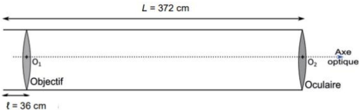
**Etape 1** : on commence par déterminer à l'aide de cette figure la distance  $d$  entre les deux lentilles. On a :
