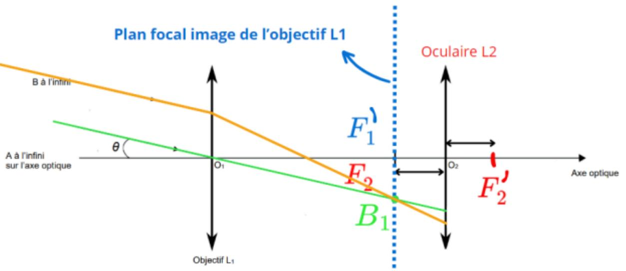
On construit le rayon issu de  $B_1$  passant par le centre de centre de la 2<sup>e</sup> lentille (rayon en rose sur la figure suivante) :
