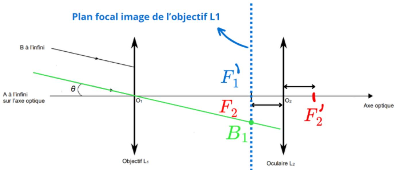
On peut également construire la marche du deuxième rayon. Ce rayon ressortira de la lentille  $L_1$  en passant par le point  $B_1$ . Il s'agit du rayon en orange sur la figure ci-après :
