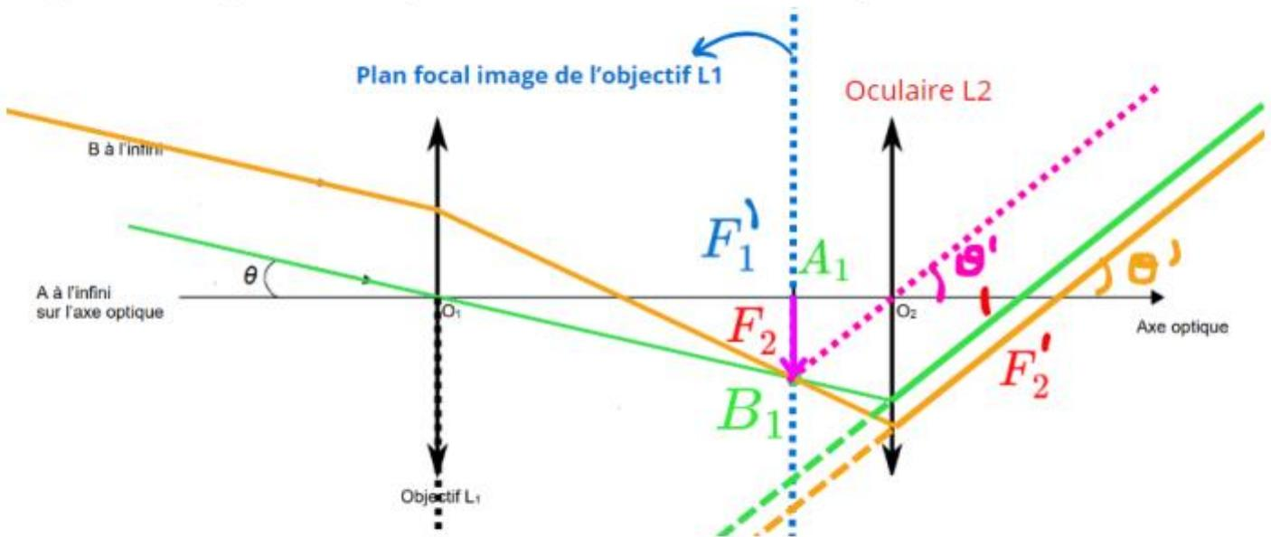
**Etape 2** : faire apparaître l'angle  $\theta$  dans le triangle  $O_1A_1B_1$  et l'angle  $\theta'$  dans le triangle  $O_2A_1B_1$  comme sur la figure ci-dessous :
