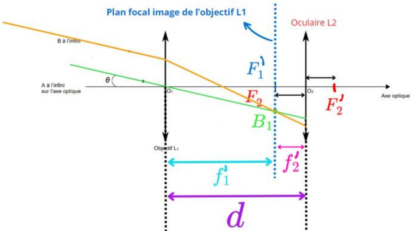
**Exemple** : Considérons deux lentilles  $L_1$  et  $L_2$  de distances focales respectives  $f_1' = 329 \text{ cm}$  et  $f_2' = 7,0 \text{ cm}$ . On considère également le schéma de principe ci-dessous représentant la lunette astronomique :
