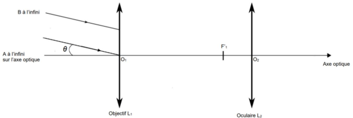
Sur la figure, les rayons arrivent bien sur la lentille de gauche, il s'agit donc de l'objectif. On en déduit que la deuxième lentille représente l'oculaire.
